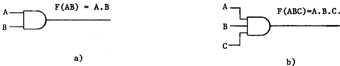
Figura 3.4 Símbolos para una compuerta AND. a) Compuerta AND de 2 entradas. b) Compuerta AND de 3 entradas.
