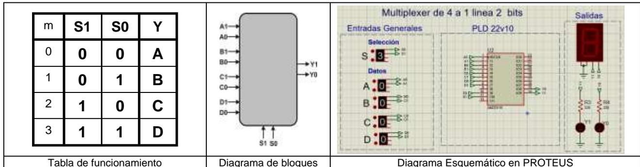
Para el diseño del selector de datos, se utilizará el Lenguaje de Descripción de Hardware ABEL-HDL, haciendo uso de los comandos When y Then. Además, se empleará el comando SET para representar una sola variable como un conjunto de valores, por ejemplo: las entradas de datos A= [A1,A0]; B= [B1,B0]; C= [C1,C0]; D= [D1,D0]; las entradas de control, S= [S1,S0]; y la salida Y=[Y1,Y0];.
