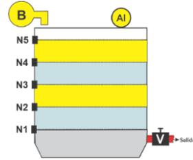
La salida de los sensores de nivel con valor igual a 1 indica que están igual nivel o por encima del sensor y el valor de 0 cuando el nivel está por debajo del sensor. El tanque es llenado por una bomba (B) y como seguridad del sistema se requiere de una salida de alarma (AL), de manera que esté encendida (AL=1):
