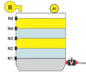
La salida de los sensores de nivel con valor igual a 1 indica que están igual nivel o por encima del sensor y el valor de 0 cuando el nivel está por debajo del sensor.
